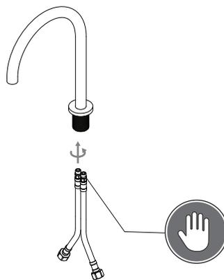
**4) O-kroužek nasuňte přes přívodní flexibilní hadice a poté celou sestavu vložte do otvoru v umyvadle.**
