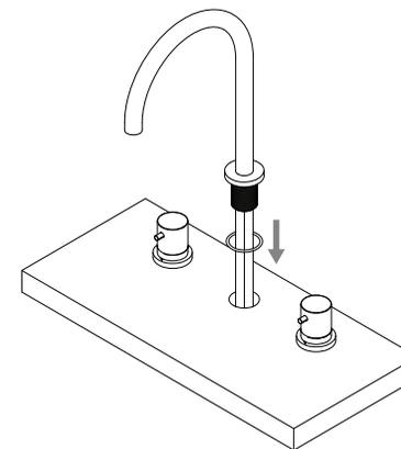
**5) Nasadte gumov  t sn ni a kovovou podlo ku upev ovac  sady. Pot  na roubujte matici na z vrtovou trubku a dot hn te ji kl čem.**
