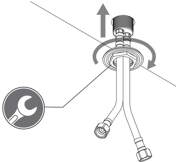
**6) Na roubujte p vodn  flexibiln  hadice do otvor  pro vstup vody ve spodn   asti t la baterie. Pot  na roubujte flexibiln  hadice propojuj c  hubici a t la baterie na bo n  stran .**
