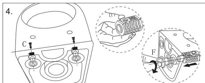
CZ - Díl C našroubujte na keramiku, pod maticí vložte těsnění E a přitáhněte klíčem F.
