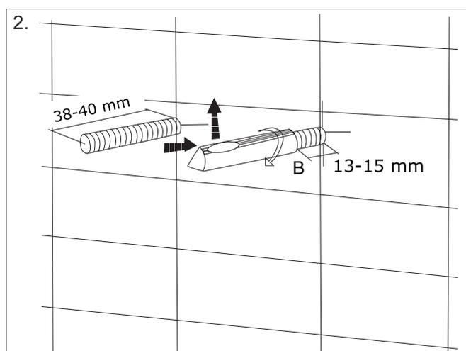
CZ - Našroubujte trn B na závitovou tyč a nastavte zářez šroubu svisle nahoru. Rozměry se můžou lišit, dle výrobní tolerance keramiky.
