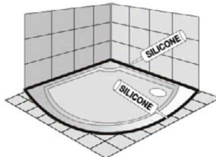
Zapustená do podlahy
