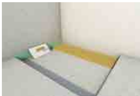
2. Příprava podkladu: očistit a vyrovnat podklad aplikací stavebního lepidla
